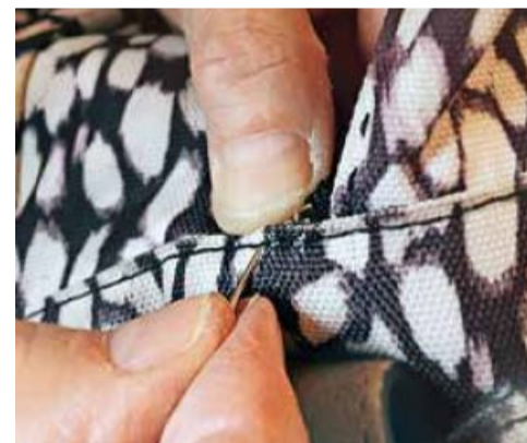
Die Naht wird von Hand aufgetrennt, damit der Reissverschluss ausgewechselt werden kann.
